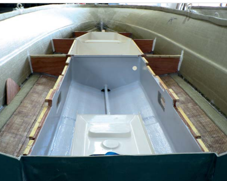
Renforts et aménagement de la coque.
