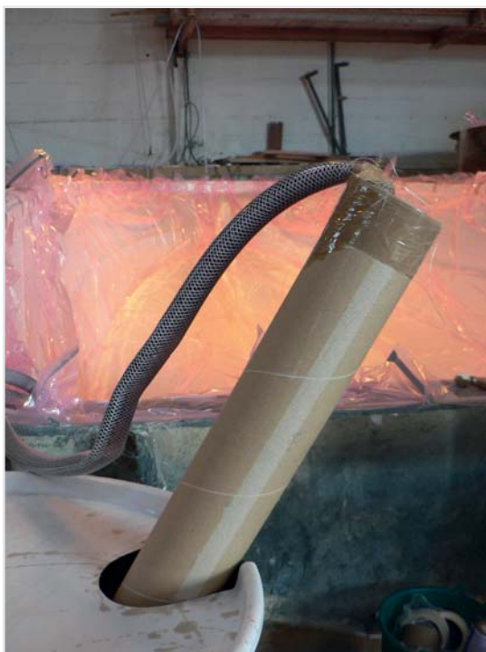
Fût dans lequel le tuyau aspire la résine qui est diffusée dans les tissus de verre.
