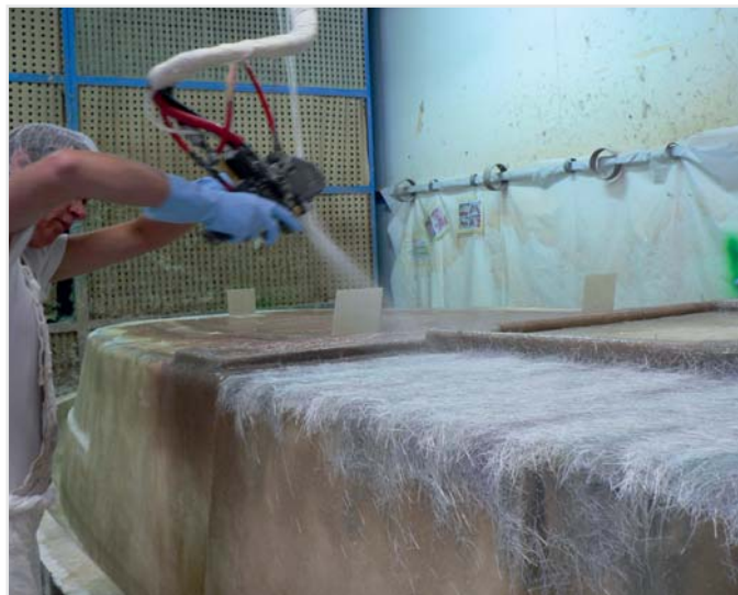
Atelier de projection simultanée pour les pièces non structurales.
